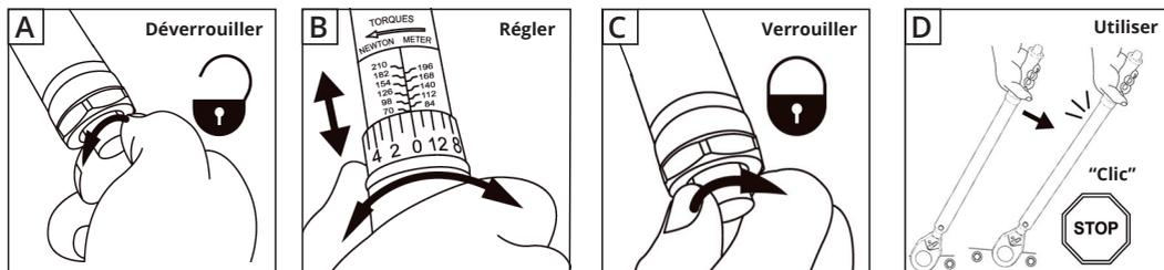
La clé dynamométrique peut être utilisée aussi bien pour les filetages à gauche que les filetages à droite. La clé à cliquet est conçue pour les douilles de 1/2".
