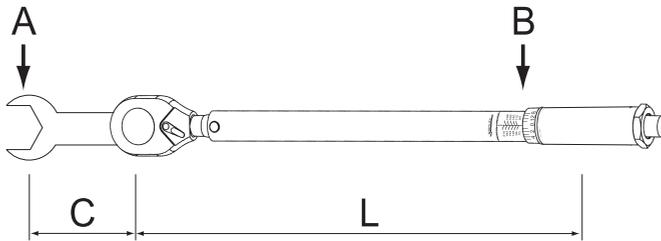
La précision du calcul ci-dessous est influencée par une série de variables, y compris la longueur de la rallonge ou de l'adaptateur, la longueur de la clé et la variation de la position de la main sur la clé dynamométrique.
