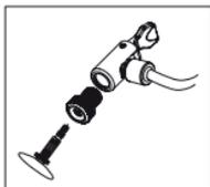
Schlauchanschluss: Den Presta-Ventil Adapter auf das Ventil am Reifen aufschrauben, den Hebelstecker (12) am Presta-Ventil Adapter (11) befestigen und den Hebel vor dem Einschalten des Kompressors herunterdrücken. Hebelstecker nach dem Aufpumpen abnehmen und anschließend den Adapter vom Reifenventil abschrauben.
