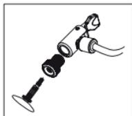
Conexión de la manguera: enrosque el adaptador de la válvula Presta en la válvula del neumático, acople el tapón de la palanca (12) al adaptador de la válvula Presta (11) y presione la palanca hacia abajo antes de conectar el compresor. Retire el tapón de la palanca después del inflado y, a continuación, desenrosque el adaptador de la válvula del neumático.
